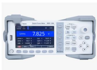
智能电参数测量仪 Intelligent Electrical Parameter Measuring Instrument
